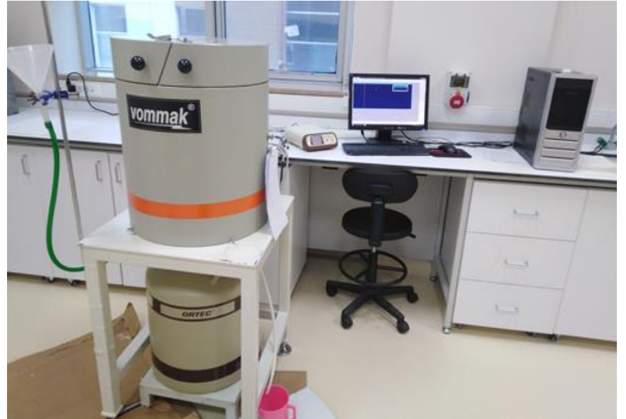
Fotoğraf 4.2 Yüksek çözünürlüklü gama-ışını spektrometresi
