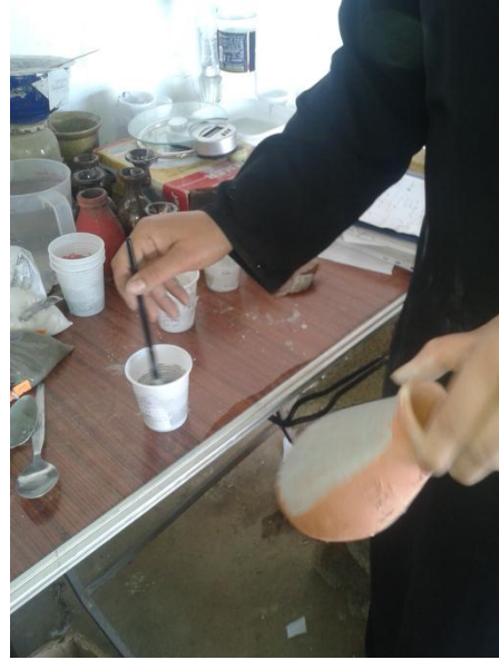
شكل (52) صور للعينات أثناء تطبيق الطلاء قبل تنفيذ العمل النهائي
