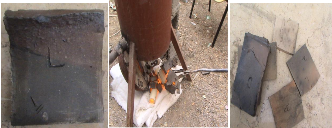
شكل (39) صورة توضح كسر وانصهار العينات
