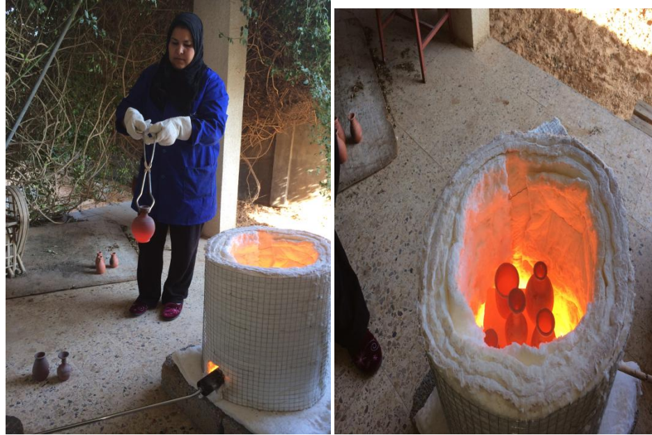
شكل (50) صورة للباحثة عند إخراج العمل ومدى تحمل العينة للصدمة الحرارية
