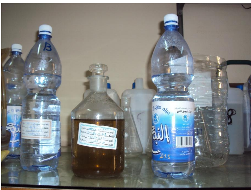
المشهد 5-10: عينات النموذج وبئر المراقبة والبئر الجوفي في معمل التحليل الكيميائي بمركز البحوث الصناعية بتاجوراء.
