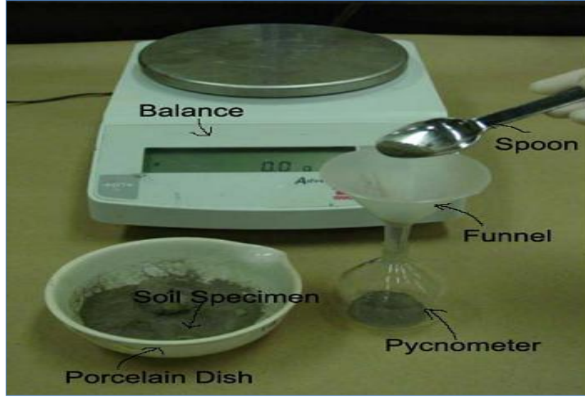
الشكل 3-7: المُعدات اللازمة لإختبارات الوزن النوعي لعينات التربة بإستخدام البيكنوميتر.
