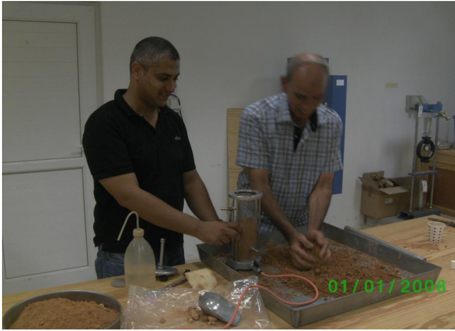
المشهد 5-7: قياس نفاذية التربة بطريقة إختبار فرق الضغط المتغير.
