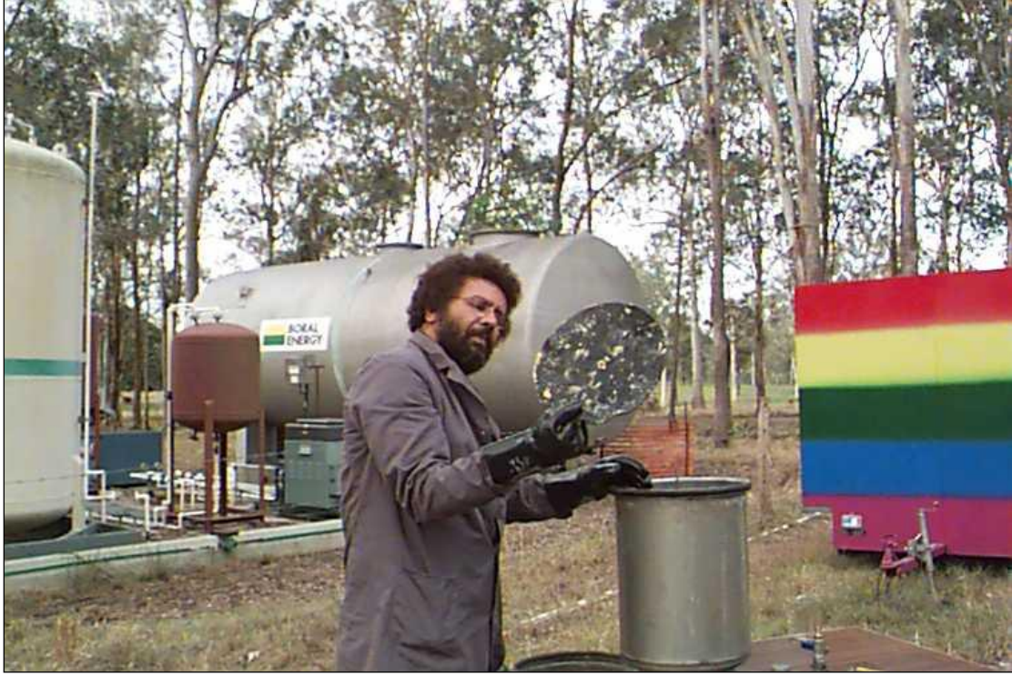
الشكل 2-18: يوضح مشرف البحث وهو يتفقد بطانة البلاستيك بعد إنتهاء فترة الاختبار فى جامعة كوينزلان[28].
