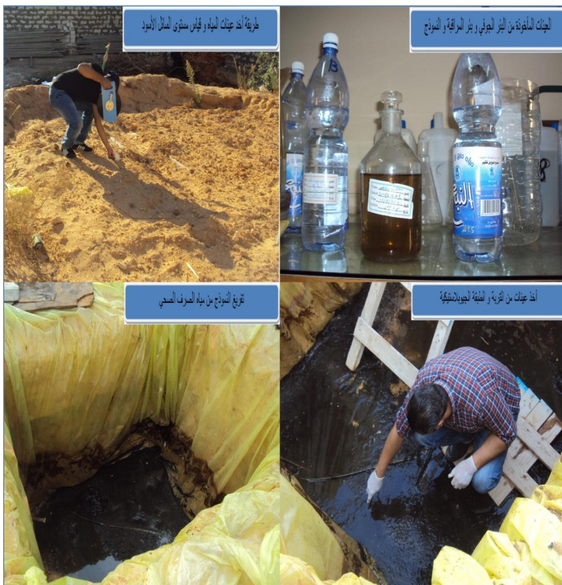
الشكل 3-22: صور للعينات المائية وطريقة أخذها قبل وبعد تفريغ عبوة نموذج البئر الأسود.
