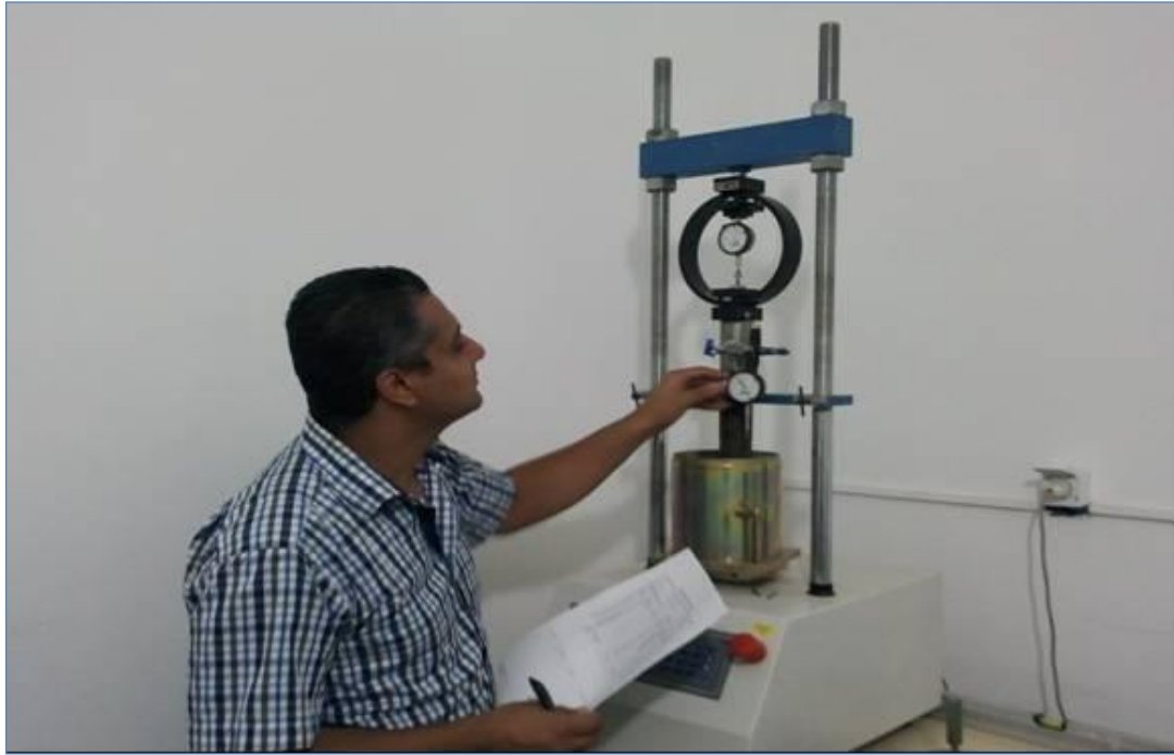
الشكل 3-12: صورة للتجهيزات المعملية المستخدمة في إختبار نسبة تحمل كاليفورنيا (CBR).
