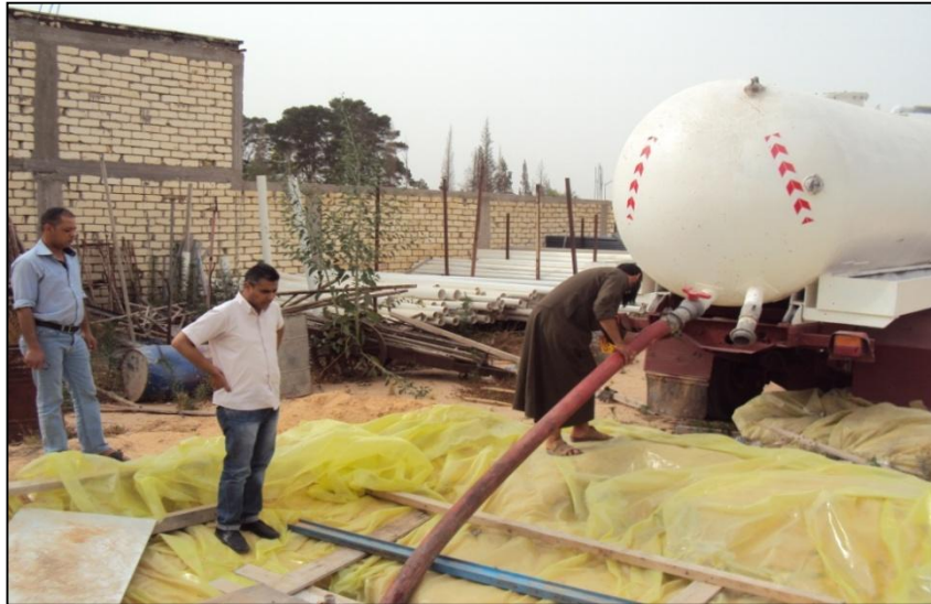
المشهد 5-5: بداية عملية تفريغ مياه الصرف الصحي داخل النموذج.
