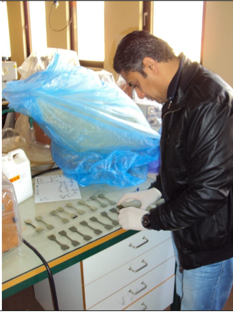
المشهد 5-14: يوضح شكل تجهيز العينات القياسية لأختبار أجهد الشد.
