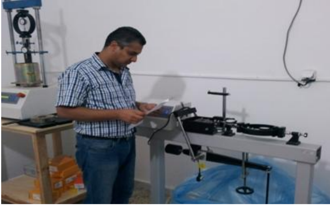
الشكل 3-15: صورة التجهيزات المعملية لإختبار إجهاد القص المباشر في معمل التربة.
