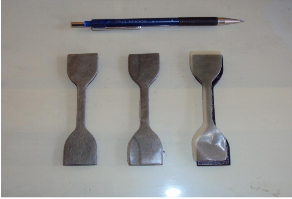
الشكل 5-4: الأشكال الهندسية القياسية للعينات المجهزة لإختبارات إجهاد الشد للبطانة الجيوبلاستيكية.
