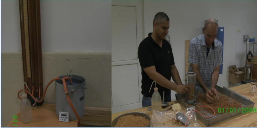
الشكل 3-8: صورة للتجهيز المعملّي لقياس نفاذية التربة بطريقة إختبار فرق الضغط المتغير.
